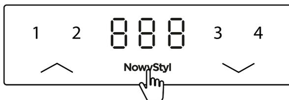
4. Mesurer la hauteur réelle, ensuite diminuer ou augmenter le chiffre affiché à l'aide du bouton « **haut** » ou « **bas** », jusqu'à l'obtention de la hauteur correcte.
