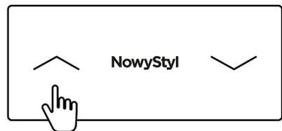
Die „**Abwärts**“ / „**Aufwärts**“-Bewegung des Schreibtisches wird fortgesetzt, bis die Taste losgelassen wird oder die niedrigste / höchste jeweils mögliche Position erreicht ist.
