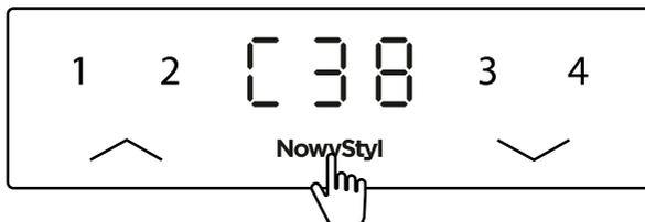
Die Werkseinstellungen werden wiederhergestellt. Auf dem Display erscheint das Symbol **C38**. Beenden Sie den Vorgang, indem Sie die Systeminitialisierung / Erste Inbetriebnahme durchführen - (7.1).
