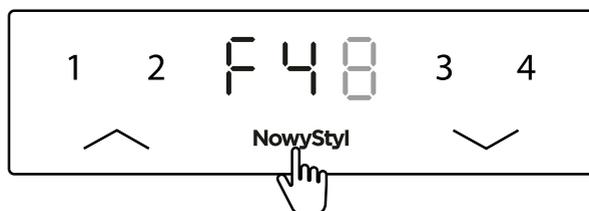
Na wyświetlaczu pojawi się podświetlony pasek. Przy wysokości stołu 960 mm ruch biurka w dół zostanie zablokowany. Przy wysokości stołu 980 mm i większej ruch blatu w górę zostanie zablokowany.
