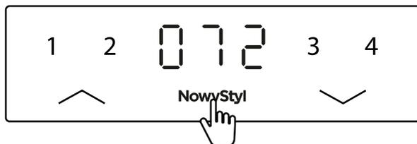
Aby wyjść z menu bez dokonywania wyboru, odczekaj około 10 sekund, aż ponownie na wyświetlaczu pojawi się wartość wysokości.
