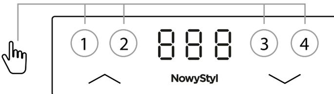
Die Höheneinstellung wird unter der gewählten Ziffer gespeichert, das Display zeigt ein Symbol an, z. B. P 1. Nach etwa 2 Sekunden wird der Wert der gespeicherten Höhe angezeigt.
