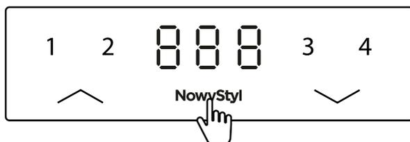
4. Zmierz rzeczywistą wysokość, następnie za pomocą przycisku „w górę” lub „w dół” zwiększ lub zmniejsz cyfrę na wyświetlaczu do odpowiadającej rzeczywistej wysokości.
