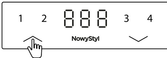
Die „**Abwärts**“ / „**Aufwärts**“-Bewegung des Schreibtischs wird fortgesetzt, bis die Taste losgelassen wird oder die niedrigste / höchste jeweils mögliche Position erreicht ist.
