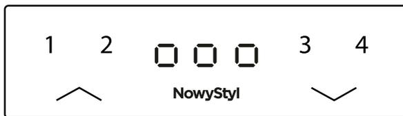
Bei einer Tischhöhe von 980 mm und mehr wird die Aufwärtsbewegung des Tisches blockiert.
