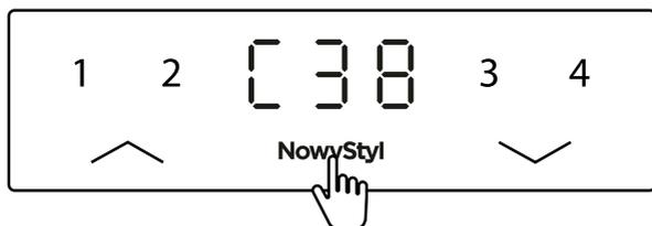
Les paramètres par défaut ont été restaurés. Le symbole **C38** s'affichera sur l'écran. Terminer le processus en réalisant l'Initialisation du système/Première mise en marche: (7.1).
